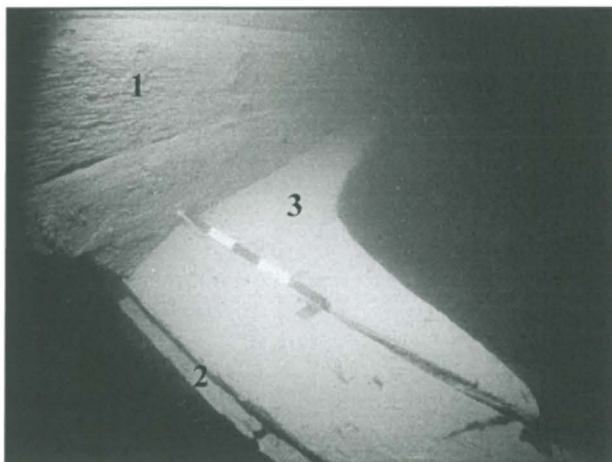
200016:58 Kuva perästä, hylyn ulkopuolelta takaapäin kohti BB laitaa. BB laidan karneerausta vasemmalla (1), alareunassa perän ulkolaudoituksen lankkujen päät (2). Sisäpuolella häkkipalkin vaakapolvi (3). Kuva Juha Flinkman, SMM.
