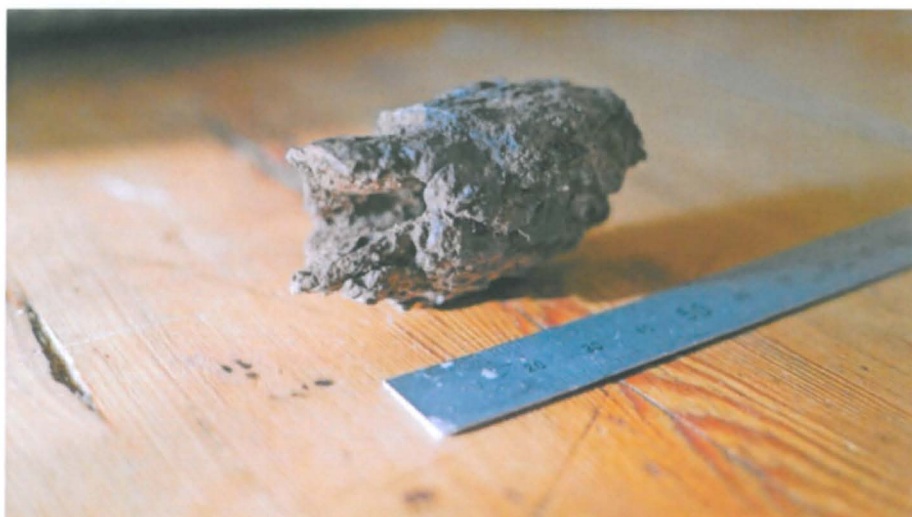
Todennäköisesti palkeiden suutin – rautaa? Suuttimeen on ehkä taottu lisäholkki palamisen estämiseksi? Sisäosa on kartiomainen ja suuttimen halkaisija on noin 8–10 mm.
