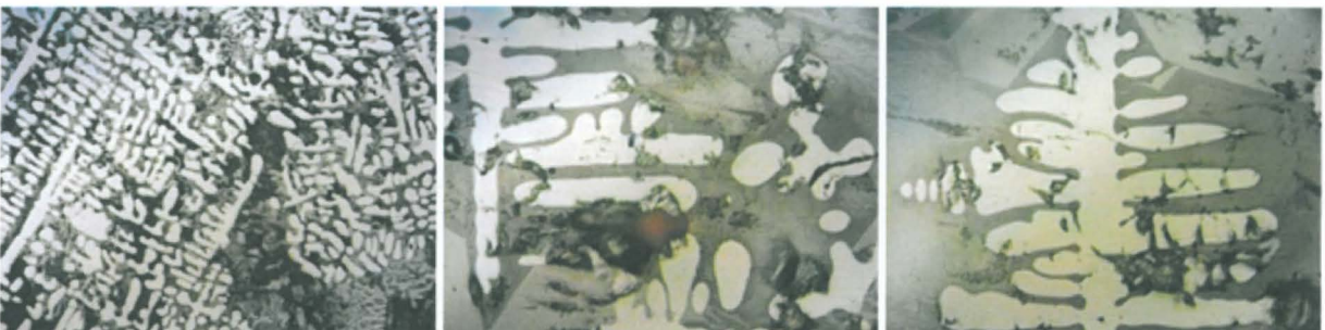
Viirankosken maanpäällisen ahjon vierestä havaittiin myös useita raudanvalmistusuunin jäänteitä, sekä raudanvalmistuskuonaa, jossa esiintyy runsaasti heterogeenisiä kuusimaisia västiittihentymiä. Kuonan mikrorakenne vastaa tyyppillistä rautakautisen raudanvalmistuskuonan rakennetta (Park, Rehren 2011; Blakeloc, Martín-Torre, Veldhuijzen, Young 2009; Buchwald 2005, 2003; Hjärthner-Holdar, Kresten, Larsson 1997, Peets 2003; Pleiner 2000, 2005 ja 2006). Seppä saattoi käyttää raaka-aineenaan romu-
