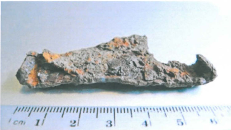
Kolmikärkisen jääkengän korrosio on edennyt magnetiitiksi. Vai onko kyseessä sittenkin jonkinlainen vyön tai henkselien solki?
