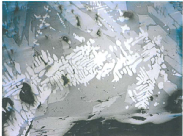
Kuona sisältää myös hiiliteräksen sulaneita kappaleita, jotka ovat ehkä peräisin kierrätetystä teräksestä. Hiiliterästä on toisaalta voinut syntyä myös hiilen diffuusiona ahjossa, kuumennettaessa niukkahiilistä rautaa.
