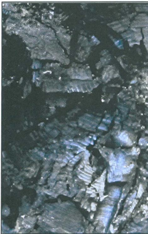
Liitekuva 2. Hiiltymisessä vääntyneitä ja katkenneita vuosilustoja Oulun Lyseon pihan näytteessä DN2 (kuva: Marika Hyttinen).
