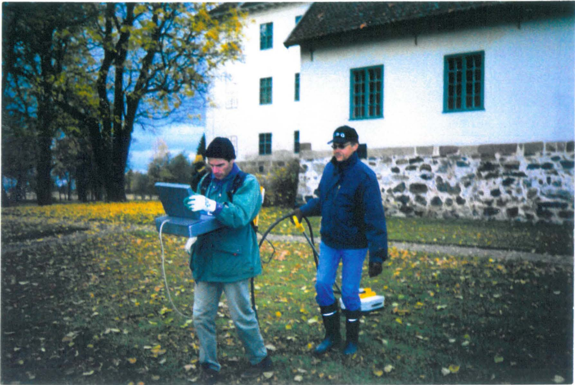
Kuva 8. Maatutkaluotauksella tutkitaan maakerrostumien rakennetta sekä kalliopinnan sijaintia ja sisäisiä rakenteita.
