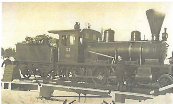
Veturi n:o121 on Tornion veturitalin ns. kääntöpöydällä. Veturin ohjaimissa Raisen ja edessä oikealla konduktööri Söderman. Veturi on tyyppiä SK 1 ja valm. 1885 Sveitsissä. Kuva vuodelta 1910.
