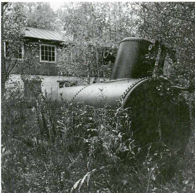
Pannuhuoneen entinen tuli- torvikattila Strömman saha- rakennuksen edustalla. Valok. Erkki Härö 1994.
