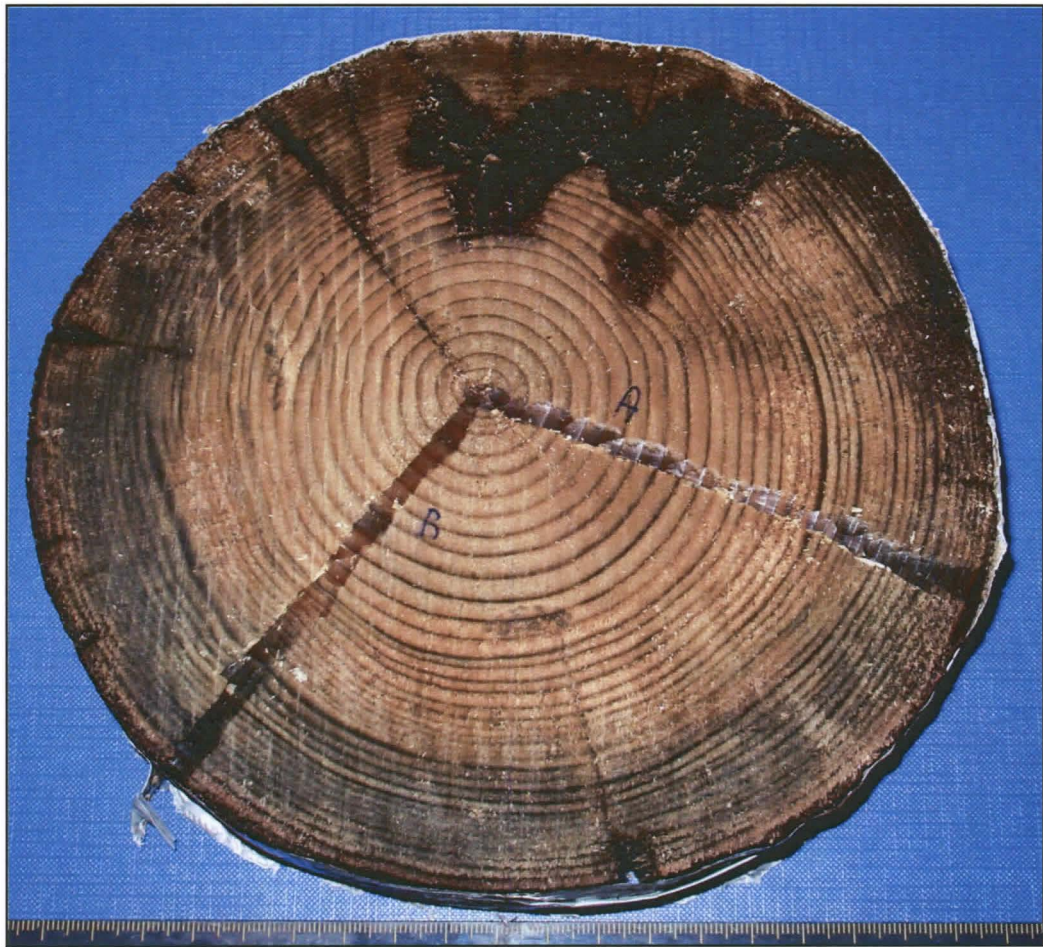
Liitekuva 1. Dendrokronologinen näyte F4V3201 kasvuhäiriöisestä vahingoittuneesta kuusesta. Epäsäännölliset vuosilustot näkyvät selvästi esim. B-mittauslinjan puolivälissä, sekä A-mittauslinjan yläpuolella kiekon yläosassa.
