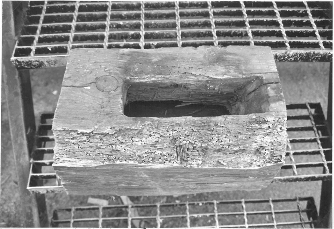
OSA YLIMMÄSTÄ TASAKERRASTA SALVOKSEN KOHDALTA. NAHTAVISSA SEKÄ HIRSIJUMIN EITÄ KUOLEMANKELLON LENTOAUUKKOJA. KUVA 1.
