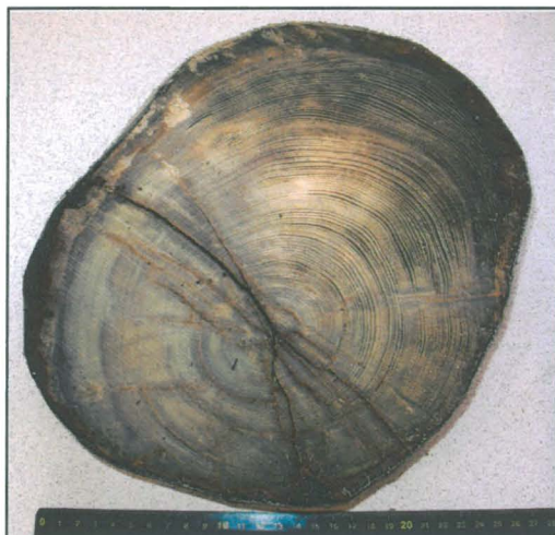
Kuvat 3 ja 4. Ajoitusnäyte F4O3505 kallistuneena kasvaneesta rungosta jossa on runsaasti reaktiopuuta (kuva vasemmalla) sekä pihkataskuja (mikroskooppikuva oikealla).
