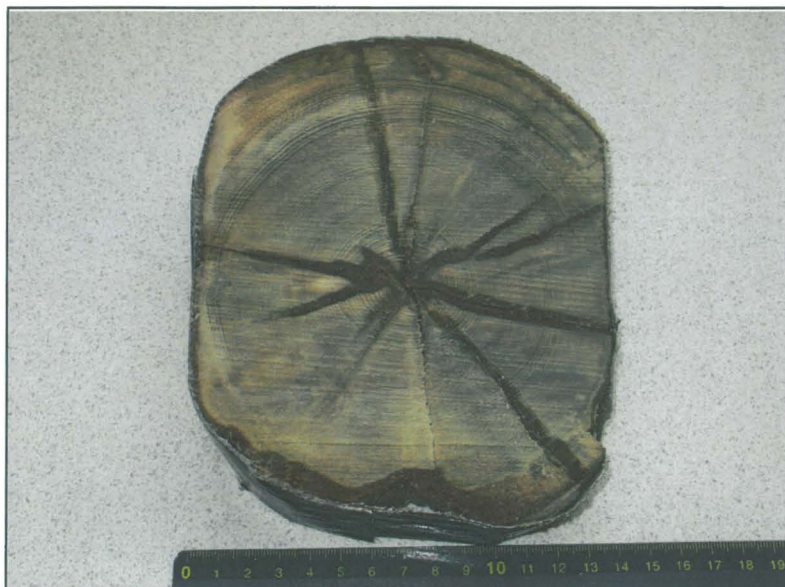
Kuva 2. Ajoitusnäyte molemmilta sivuilta veistetystä hirrestä. Alla oleva ilmeinen varaus tarkoittaa sitä, että hirsi on alunperin ollut seinän osa.
