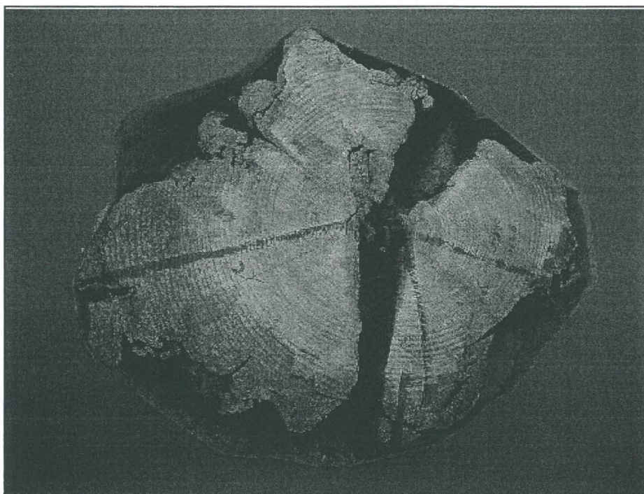
Kuva 1. Dendrokronologinen ajoitusnäyte FIO3101. Kolme mittauslinjaa näkyvät kapeina tummina kaistaleina ytimestä pintaan. Ydin- ja pintapuun mahdollinen raja erottuu lahonneisuuserona kappaleen vasemmassa osassa vaalean ja tumman rajavyöhykkeenä.
