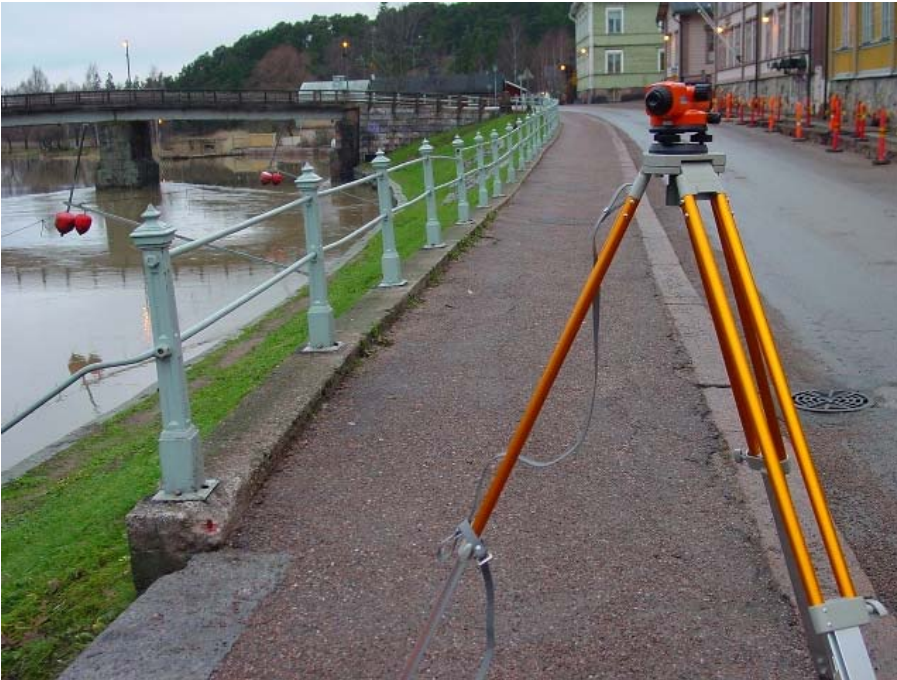
25. Yleiskuva; kiintopisteenä käytetty metallipultti näkyy vasemmalla kaiteen perustuskivessä.
