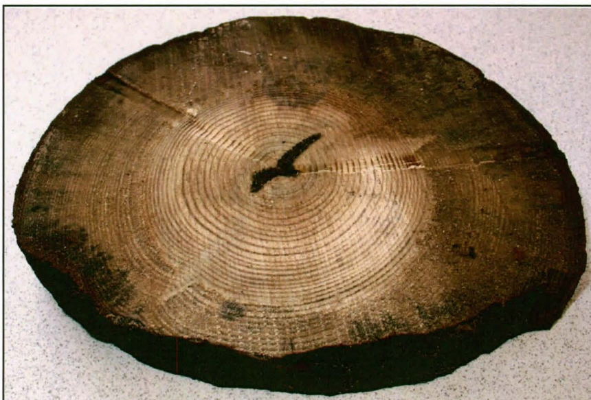
Kuva 8. Lähes lahoamattoman sydänpuun ja lahonneemman mantopuun välinen raja erottuu selvästi näytekiekossa FIU5506.
