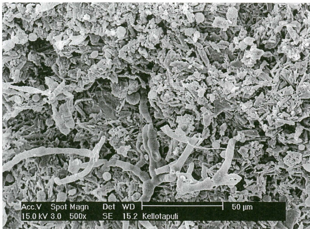
Kuva 10. Kellotornin vaurioituneen kipsin pintarakennetta
