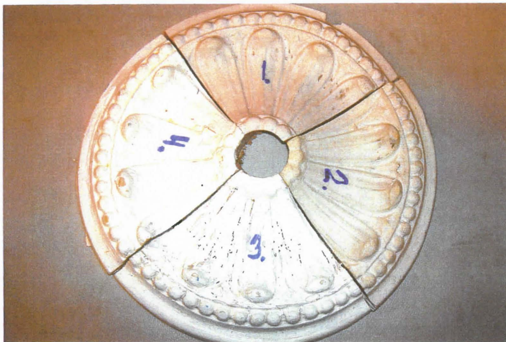
Kuva 20. Neljään osaan jaettu kipsiornamentti pakkas-sulatuskokeiden jälkeen. (1) puhdas kipsi, (2) vernissattu kipsi, (3) TEHO öljymaali ja (4) vernissattu pohja ja TEHO öljymaali pinnassa
