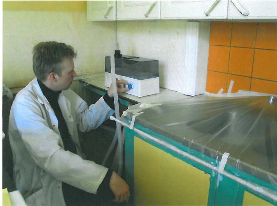
Tiskipöydälle rakennettiin väliaikainen kosteuskammio.
