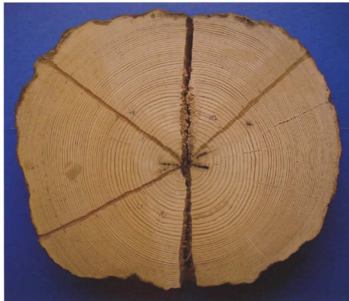
Kuva 1. Poikkileikkaus Lappeenrannan linnoitustyössä esiin tulleesta rantapaalusta. Kolme linjaa joilta vuosilustot on mitattu näkyvät tummina. © Pentti Zetterberg
