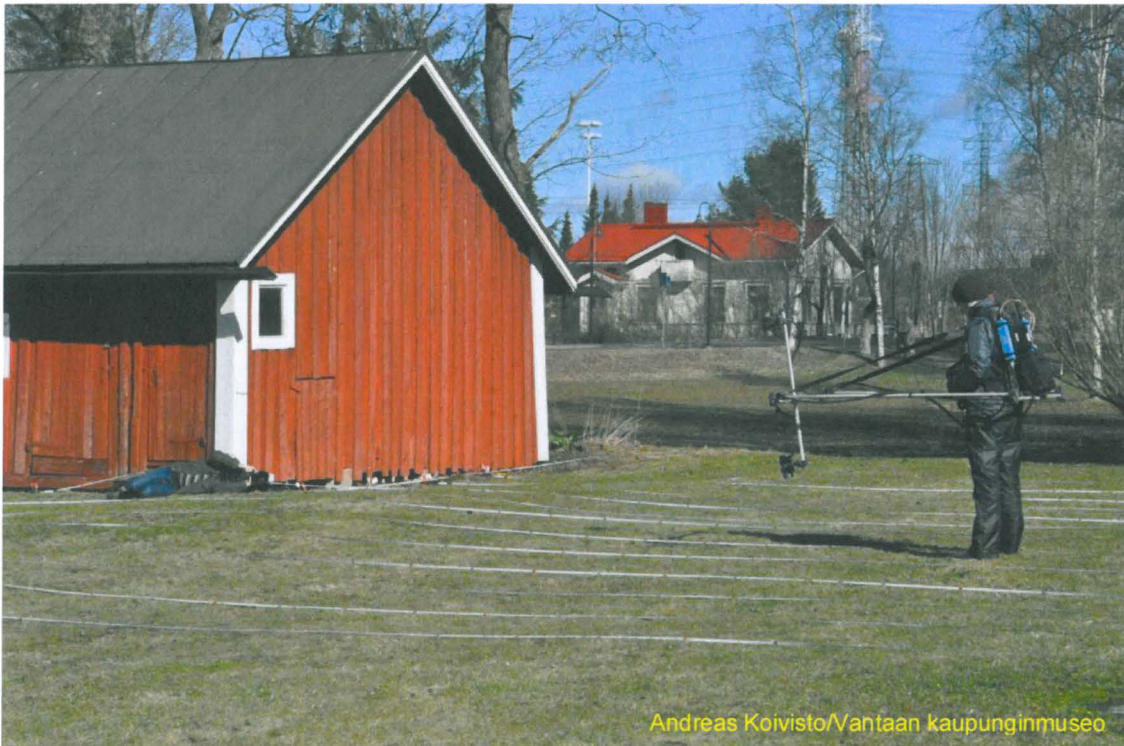
Kuva 5. Magnetometrimittauksia tehtiin 0,5 metrin välein. Kuvassa näkyvä mittausalueen 2 laidalla ollut rakennus aiheutti häiriötä mittauksiin.
