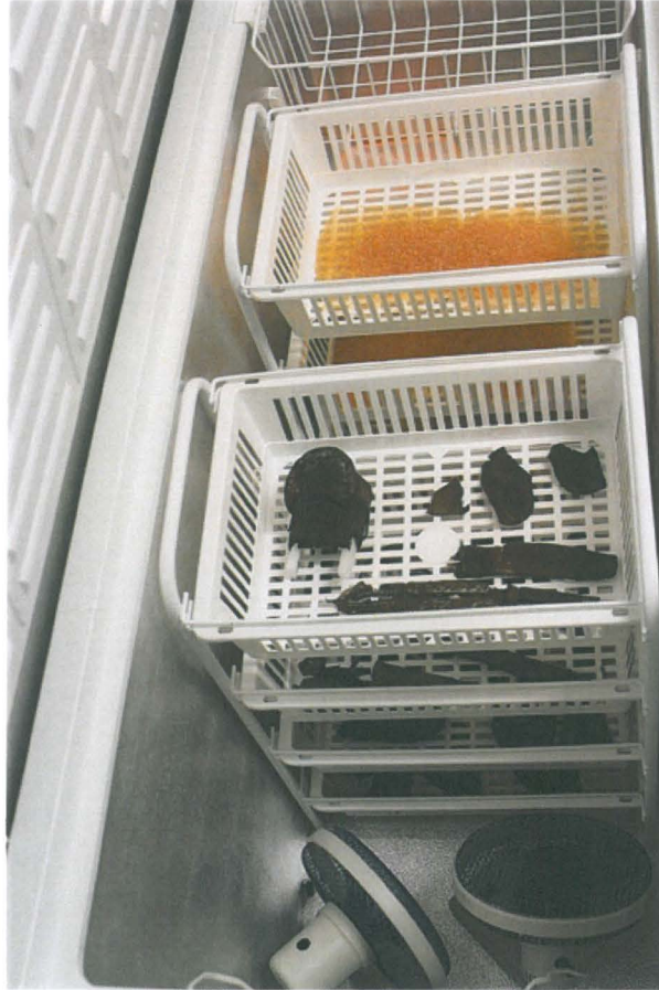
Alemmassa korivaunussa on kuivatuksessa olevat nahat. Ylemmässä korivaunussa on kosteutta poistamassa silicageeliä. Tuulettimet kierrättävät pakastimessa ilmaa kuivauksen aikana.
