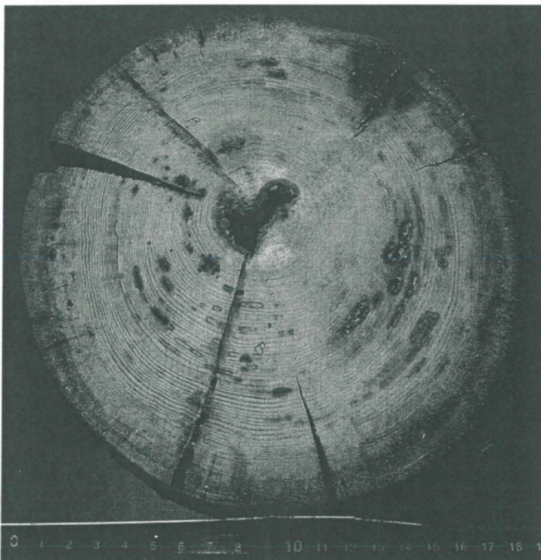
Liitekuva 3. Dendrokronologinen näyte F4T0713, ytimestä lahonnut veistämätön hirsi.
