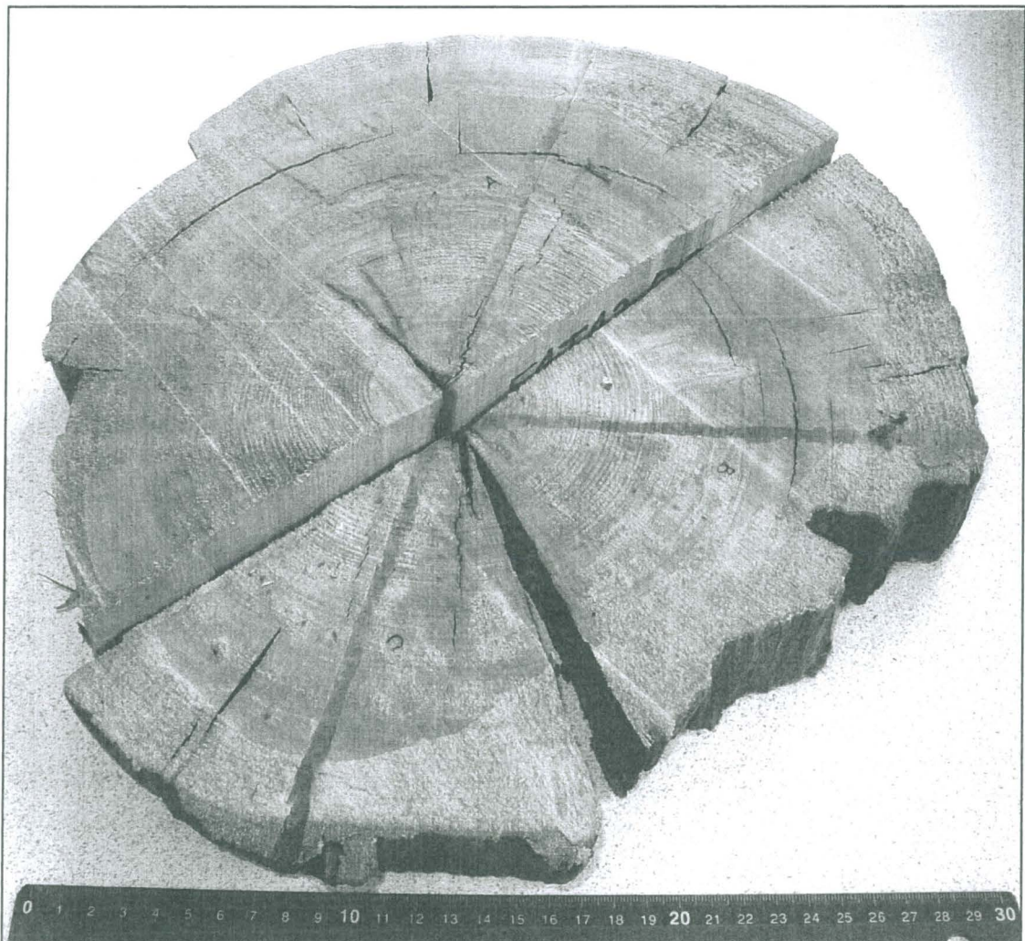
Liitekuva 3. Turun Tuomiokirkonkadun dendrokronologinen ajoitusnäyte F1T1303. Mittauslaitteiston liian suuri (halkaisija 33 cm) näytekiekko sahattiin kolmeen osaan mittausten suorittamista varten.
