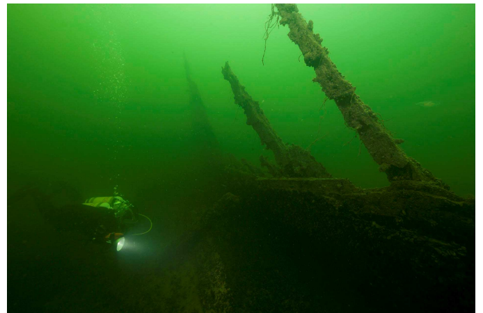
Kuva 13. Styrrpuurin kylkeä lähellä keulaa, kohti perää kuvattuna. Veistokaarissa on puutappeja, joilla laitalankut ovat olleet kiinnitettynä.
