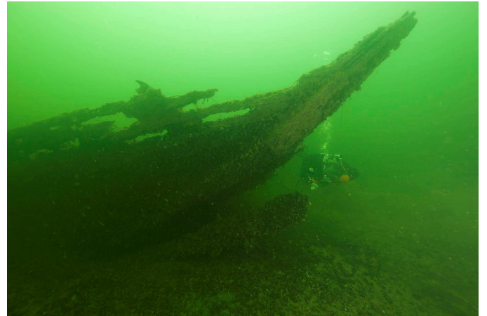
Kuva 11. Keula kuvattuna styyrpuurin puolelta. Keularangan alempi osa on revennyt irti. Limisaumaisuus havaittavissa kylkilankuissa.
