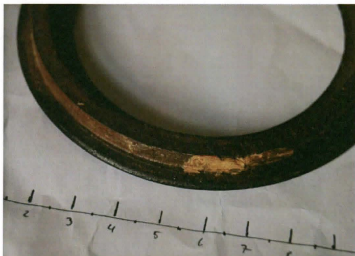
Kuva 32: Poistettavia liimajäämiä sekä lohjennutta puuta
