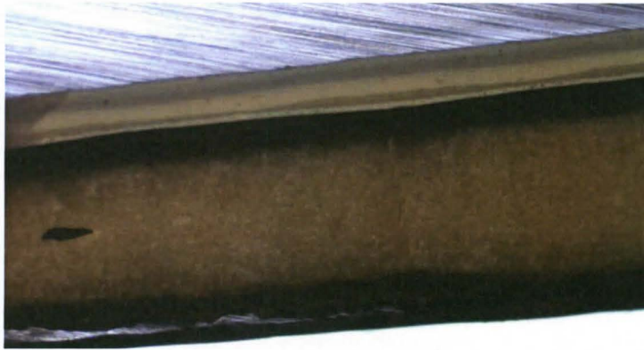
Kuva 18. Sisemmänsan poikkileikkausnäyte. Pintakerros ylimpänä. Keskimmäisestä ruskeasta kerroksesta näkyy vain vähän. Kuvaaja: Jenni Jokinen
