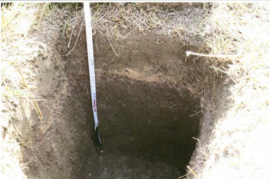
Kuva 21. Kinellin torpanpaikan koekuoppa 2 idästä. Profilissa näkyy noin 35 cm syvyydessä havaittu ohut hiekkakerros, jonka alla on karkean punasävyisen soran muodostama kerros. Kuva: Nautelankosken museon, NKM/va/88:22.
