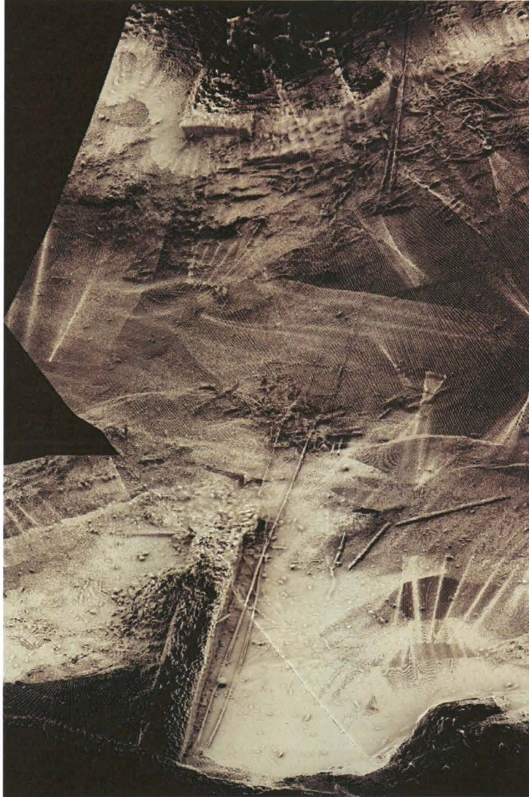
Kuva 3. Monikeilaluotainkuvan alareunassa Länsi-Mustasaaren väyläeste, jonka oikealla puolella kulkevat painevesijohtoputket kohti Särkkää ja ylhäällä keskellä Särkän väyläesteen kärki. Keskellä väylää erottuu röykkiönä mahdollinen hylky. Suomenlinnan hoitokunnan luvalla. Kuvan muokkaus Ville Peltokorpi (VP).
