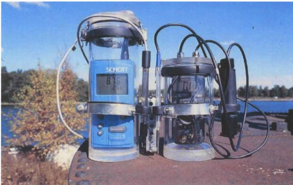
Kuva 6. Vesitiiviiseen akryyliputkikoteloon suljettu pH-mittari (vasemmalla) ja yleismittari, sekä pH-, platina-, ja vertailuelektrodit (Kuva: Rami Kokko, Museovirasto).
