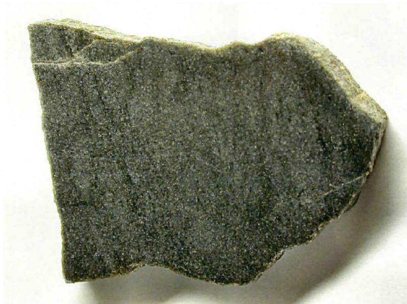
Kuva 4. Hyllyn kivisauvasta sahattu ja hiottu levynäyte. Kuvassa erottuu kiven ulkoreunoja ja hiushalkeamia ympäröivä muuttumisreunus. Kivilevyn leveys 5 cm. Kuva: Kari A. Kinnunen.
