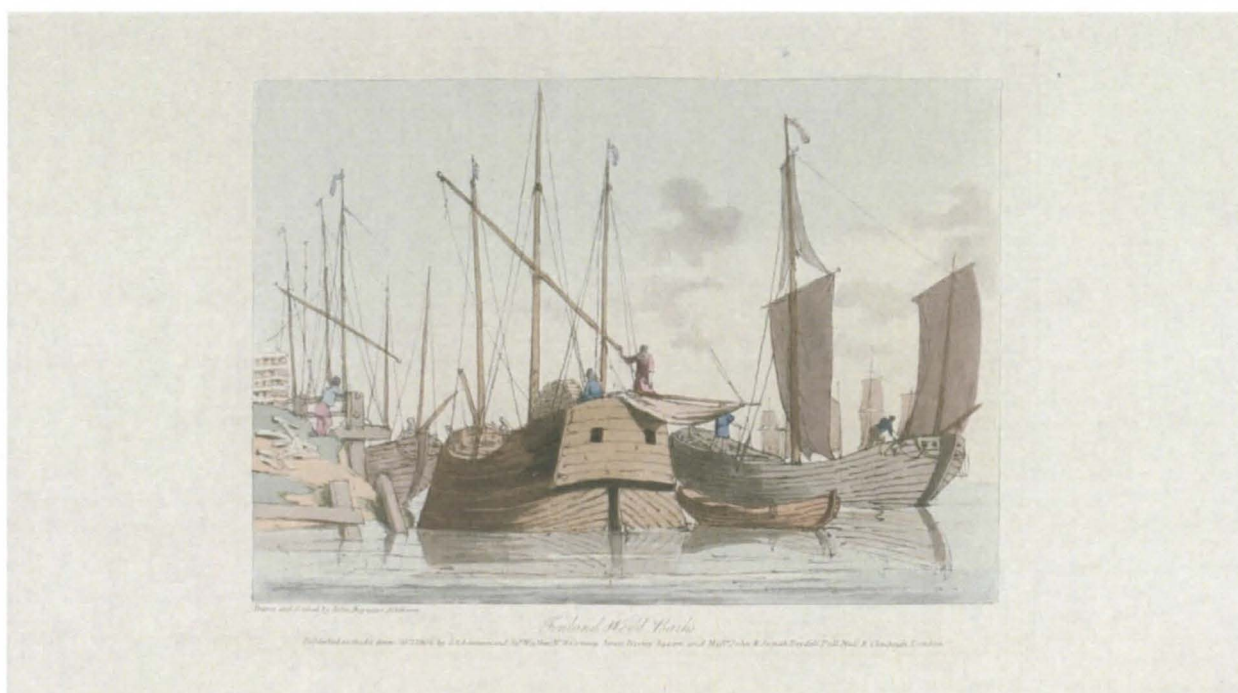
Kuva 3. Itäsuomalainen halkokuutti. Kaikki raa'at voitiin laskea alas kannelle. Atkinson – Walker: "Finland wood barks".
