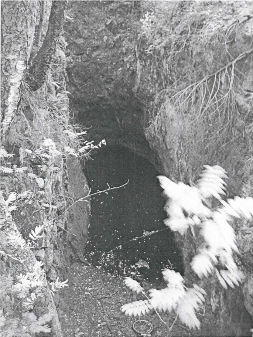
Kuvat 5-6. Yksityiskohtakuvia kaivoskuiluista, vedellä täyttyneitä.
