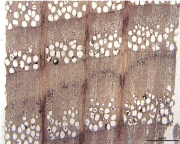
Kuva 5.18. Valomikroskooppikuva keularankanäytteestä (tammi, Quercus robur ). Kuva Tuuli Timonen / Pirkko Harju, Luonnontieteellinen keskusmuseo (MA201014:51).
