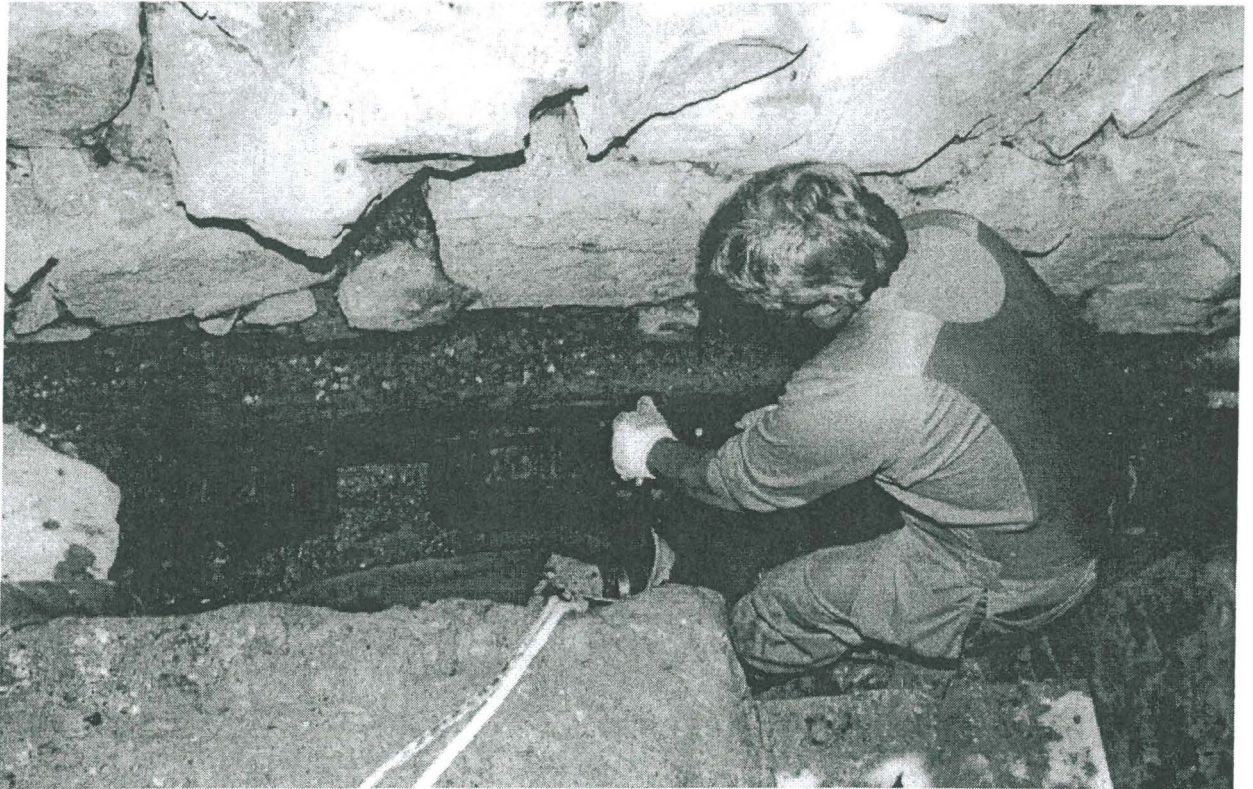
Kuva 3. Dendrokronologista ajoitusnäytettä sahataan Kuusiston linnan C-tornin eteläseinän hirsjarinasta heinäkuussa 1996. Antti Sunan valokuva.
