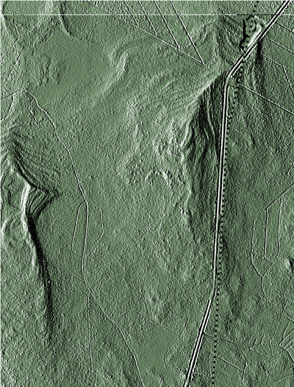
Kuva B Lidar vinovalvarjoste, Pieni Lautamaa. Maanmittauslaitoksen laserkeilausaineisto (pistepilvi) 10/2014. Voimalinja katkoviivana.
