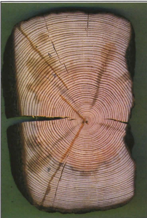
Kuva 3. Dendrokronologinen ajoitusnäyte FIY1702 Rannusinsalmen purjehdusesteistä. Sivuilta veistetty hirsi.
