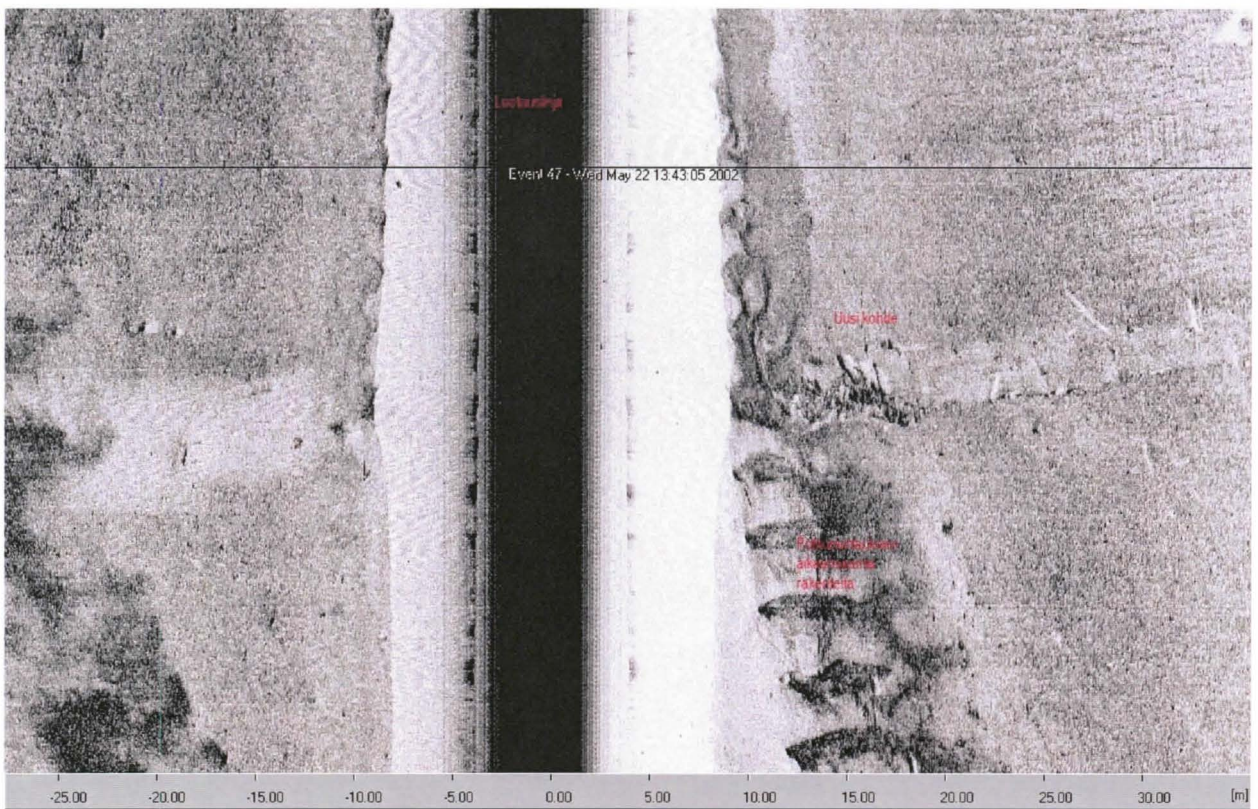
Kuva 10. Pikisaaren hylän väyläalueen eteläosassa havaittu uusi kohde viistokaikuluotaimen (500 kHz) kuvassa. Kohde nähtynä ennen reittipistettä 47 nähtynä. Luotaussuunta alhaalta ylös (lounas-koillinen). Kohteen oikealla puolella näyttäisi olevan jonkinlainen raahautumis-/valumisjälki. Alusten potkurivirtauksien aikaansaamat "aallonmerkit" näkyvät myös hyvin.
