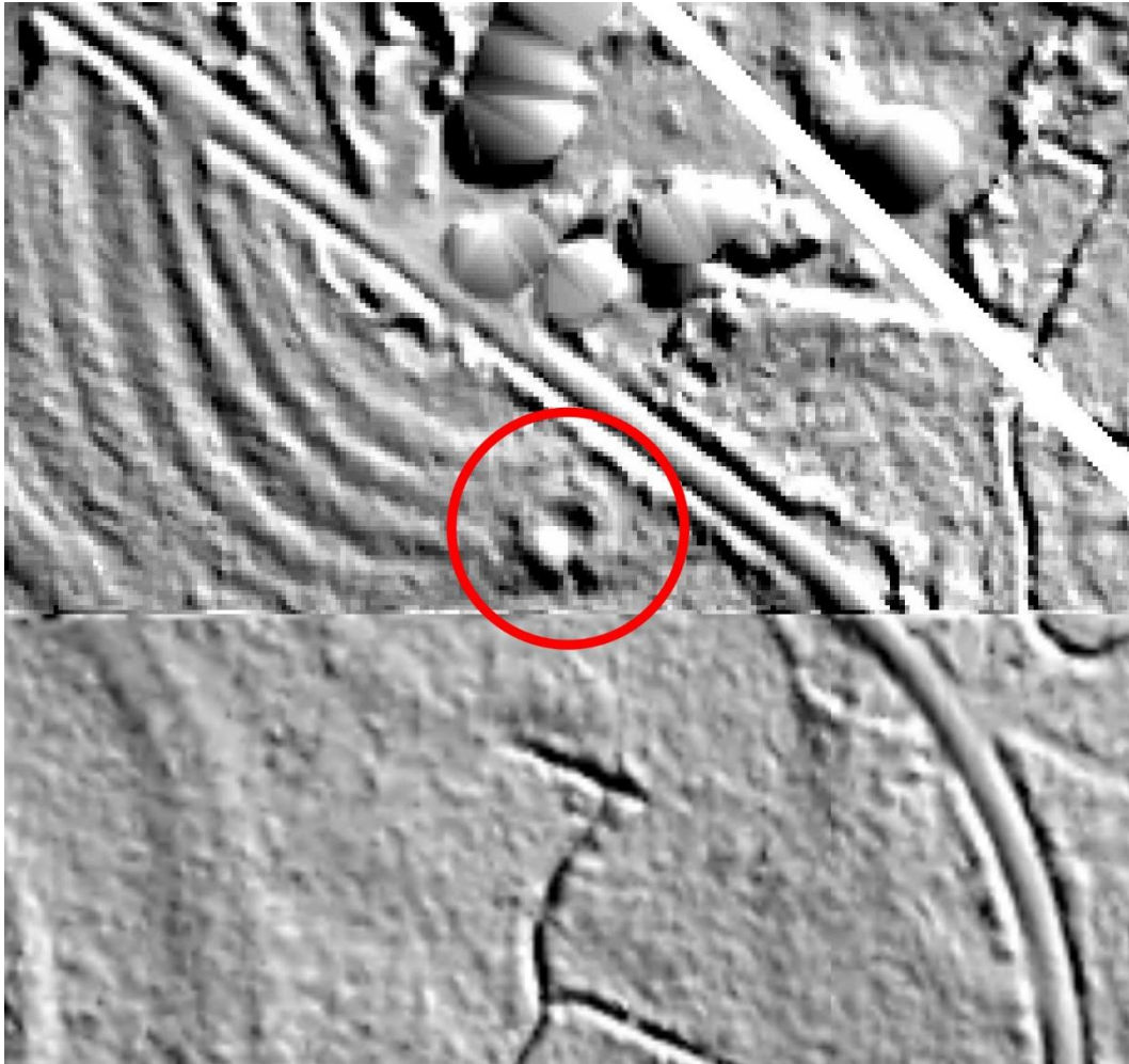
Kuva 6. Tervahauta erottuu laserkeilausaineiston tulkinnessa pyöreänä rakenteena tien eteläpuolella. Tien pohjoispuolella on hiekkakuopan rakenteita.
