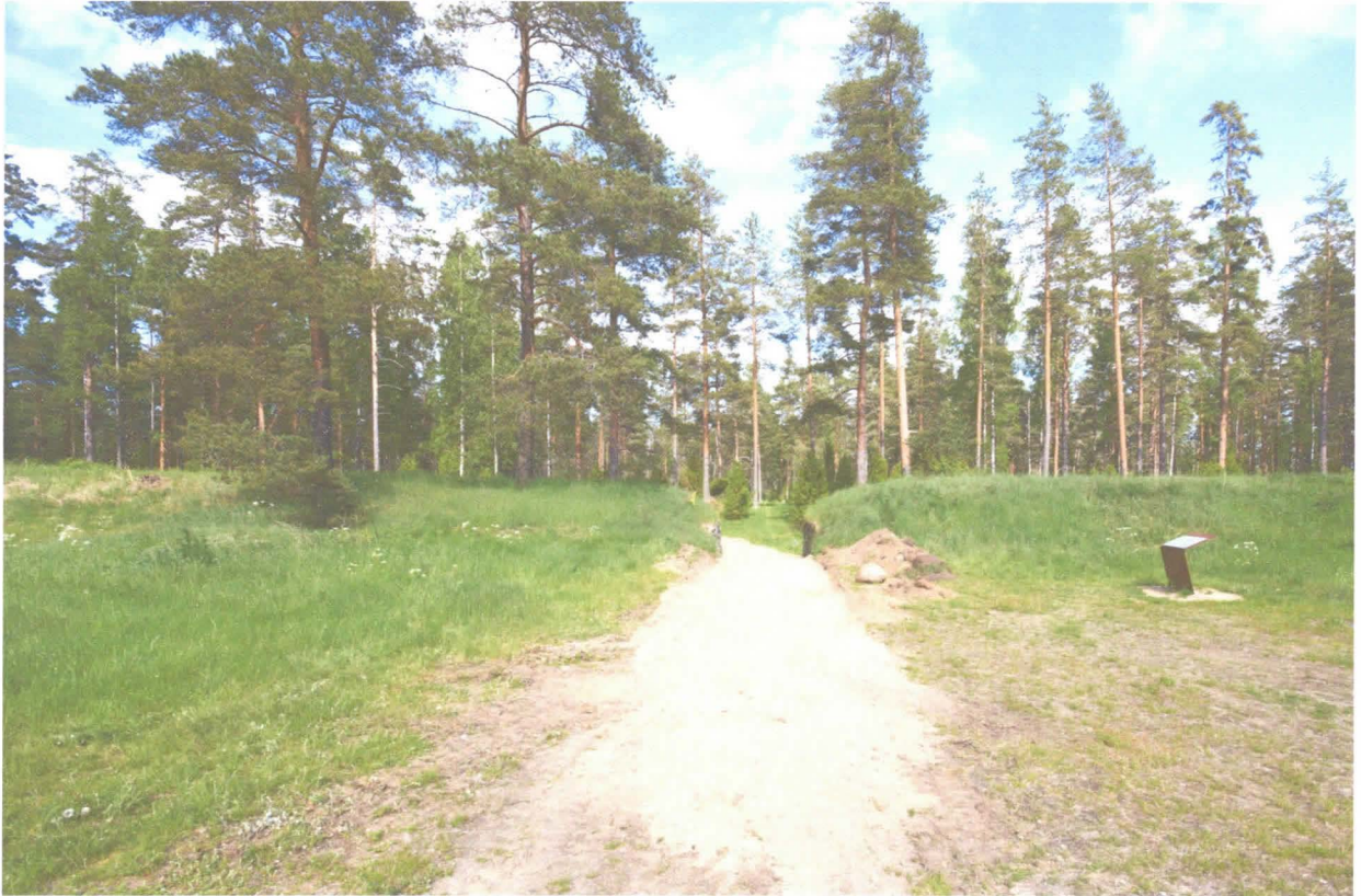
Kuva 3. Utin esteetön sisäänkäynti valmiina. Kivituuhkaa levitettiin hieman kaivantoa pidemmälle pykälien välttämiseksi.
