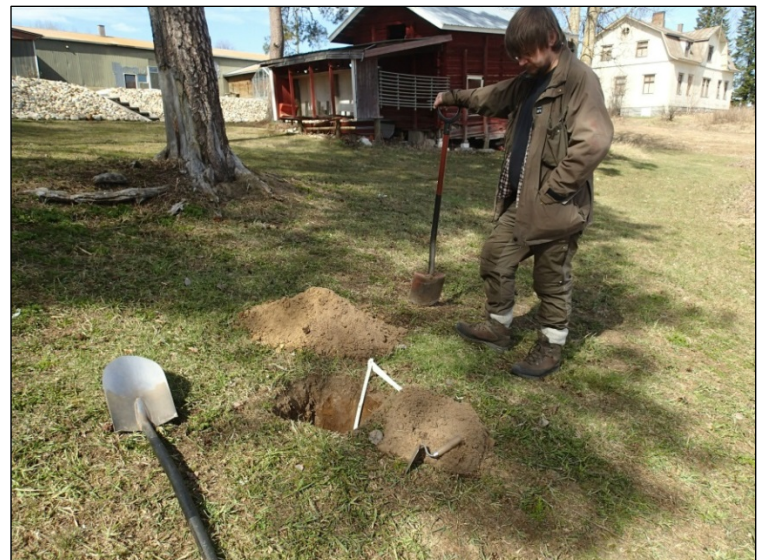
Koekuoppa 12 kertoo että paikalle on tuotu täytemaata (kuvassa T Sepänmaa).
