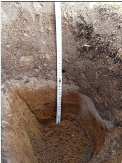
Koekuoppa 12 kertoo että paikalle on tuotu täytemaata (kuvassa T Sepänmaa).
