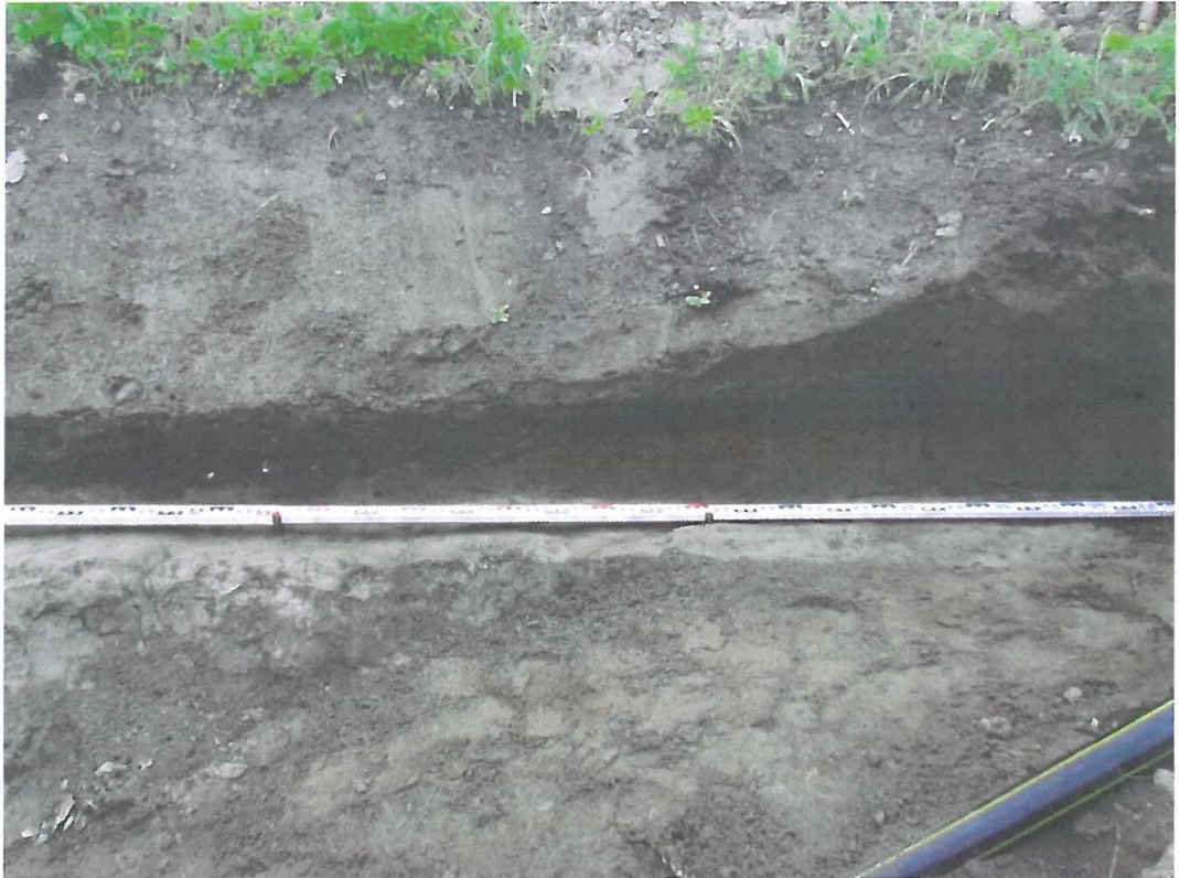
Kuva 3. Kaivannon länsiprofiilia. Tumma raita maassa kuvan keskellä on pelto-kerrokseksi tulkittu maannos. Sen yläpuolella on harmaata sorapitoista täyttömaata ja alapuolella ruskeaa hiekkaa. Kuvassa näkyvän vaalean latan alapuolella on harmaa luontaisesti kerrostunut savi.
