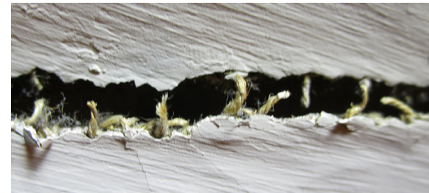
Lähikuva kankaan sauman repeämästä jossa on näkyvissä revenneet ommellangat, jotka ovat pitäneet kangasvuodat kiinni toisissaan.
