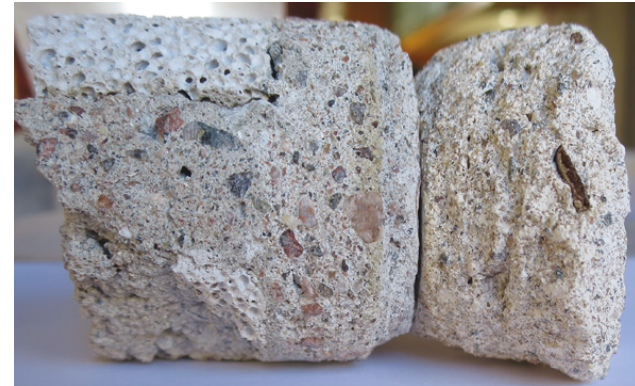
Kuvan vasemmalla puolella on näyte M1 jossa rappaus on uudempaa (maalaukerroksia 2) ja oikealla puolella näyte M4.1 jossa rappaus on vanhempaa (maalaukerroksia viisi).
