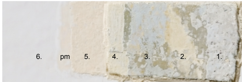
Katon väriportaikko. Jokaisen kolmen alimmaisen liimamaalin päällä on tummana erottuva eristekerros. Viides ja kuudes maalauskerrostuma ovat lateksimaaleja.
