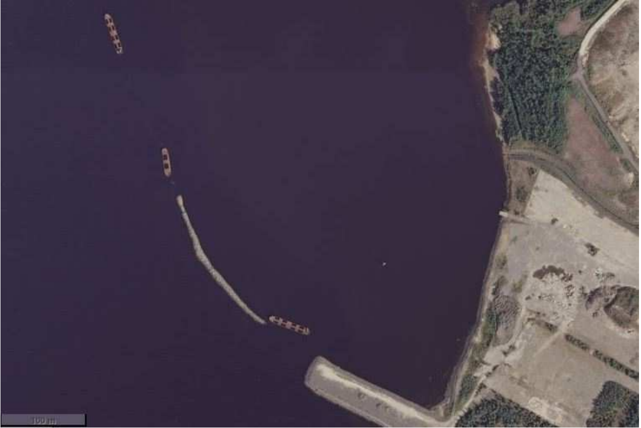
Kuva 2. Ortokuva Kiusalanniemen edustalla sijaitsevista proomuista ja aallonmurtajasta. Kolme proomuista näkyy pintaan, neljäs sijaitsee veden alla keskimmäisen proomun pohjoispuolella.
