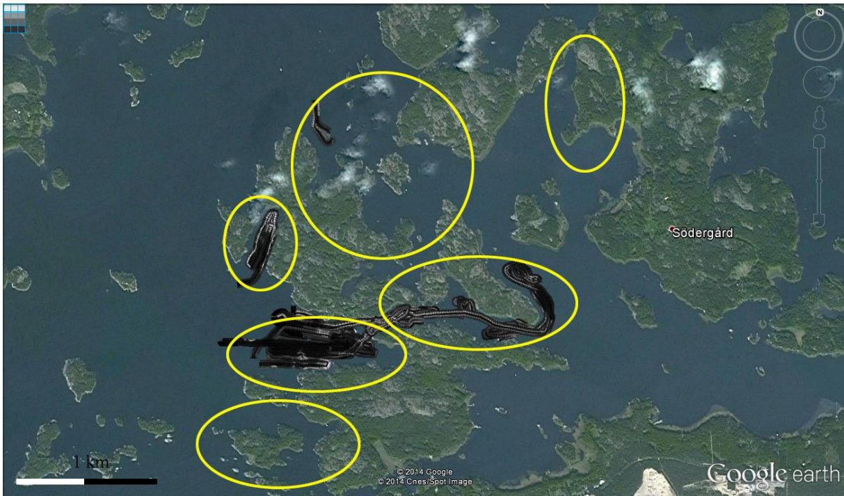
Kartta 3. Kadero-Byön ja Tränuholmenin vesialueet. Viistokaikuluotausajot sijoitettuna kartalle. Alueet, joilla on suoritettu magnetometriluotausta ja tehty tarkastussukelluksia, on rajattu suuntaa antavasti keltaisella. Karttapohja Google Earth.
