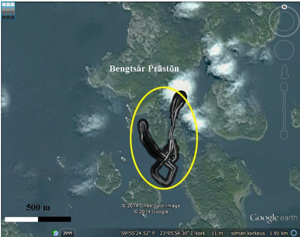
Kartta 5. Bengtsår-Prästön vesialueet. Viistokaikuluotausajot sijoitettuna kartalle. Alueet, joilla on suoritettu magnetometriluotausta ja tehty tarkastussukelluksia, on rajattu suuntaa antavasti keltaisella. Karttapohja Google Earth.
