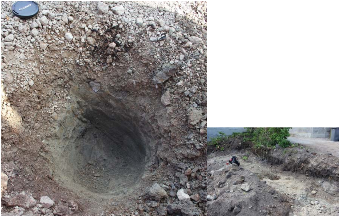
Kuva 6. Puhtaaseen soraan tehty koepisto ja sen alapuolinen savi (DT2014:119:3). Oikealla kuopan sijainti lounaisprofiilin lähellä (DT2014:119:4).
