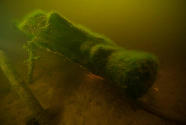
Kohde 1. Peräranka ja akselin läpivienti. Potkuri ja muut osat ovat todennäköisesti otettu talteen koneen poistamisen yhteydessä.
