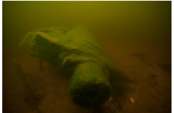
Kohde 1. Perässä on akseliputki jäljellä. Aluksen alaosa on perästä hyvin kapea. Peräranka yhdistää edelleen molemmat kyljet.
