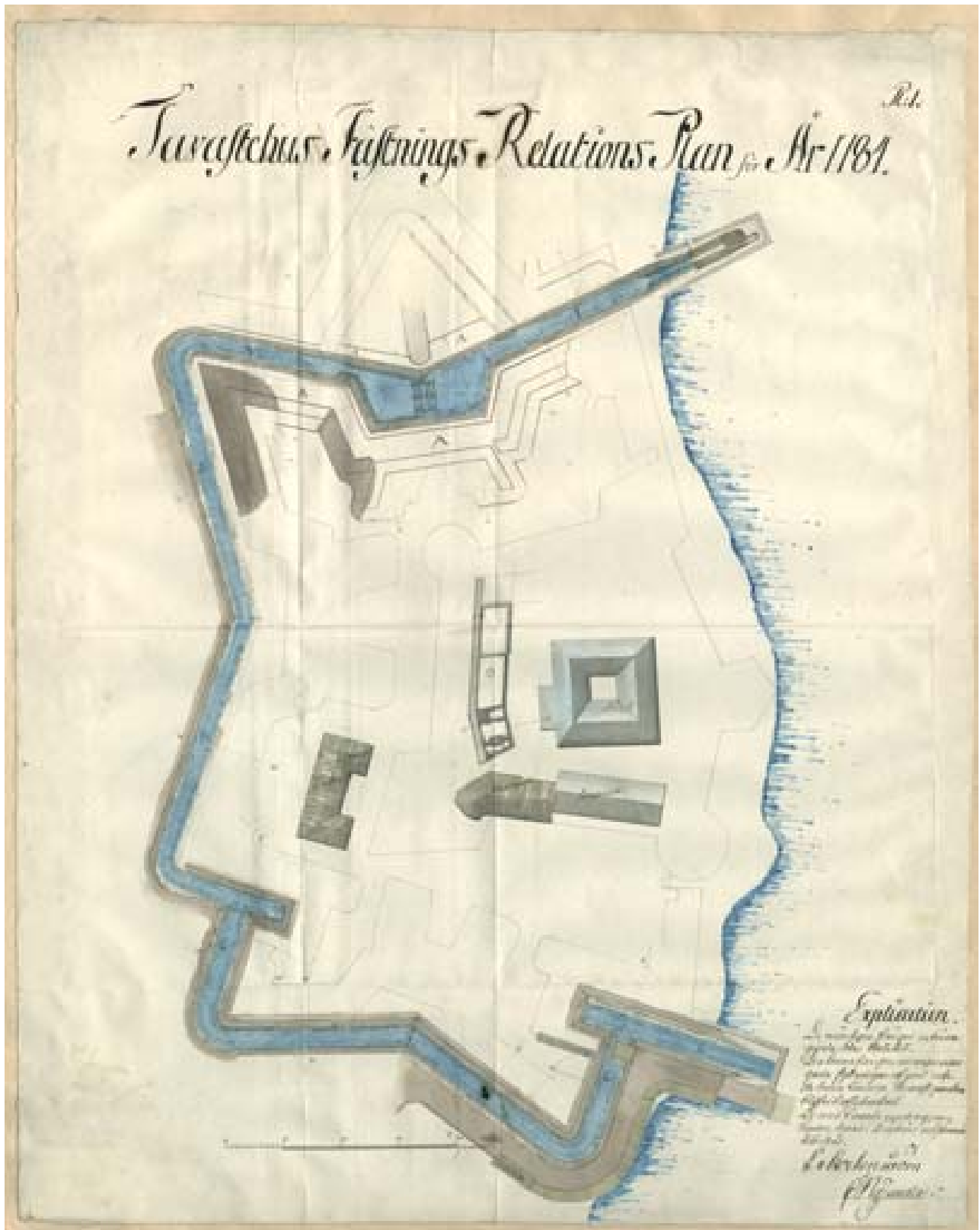
Kuva: Ruotsalaisen vuoden 1784 piirustukseen on merkitty vuoden työt. Vallihaudan päissä on patorakennelmat. Kra 0406D:12:044:137.
