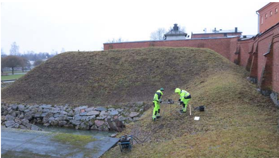
Kuva: Kairauspiste n:o 2 sijaitsi 3. puolibastionin oikean sivun maavallissa. Näyttettä kairaa-massa H-sondilla Jussi Pynnönen ja Mikko Vikman. AKDG4222:82, Päivi Hakanpää, Museovirasto.
