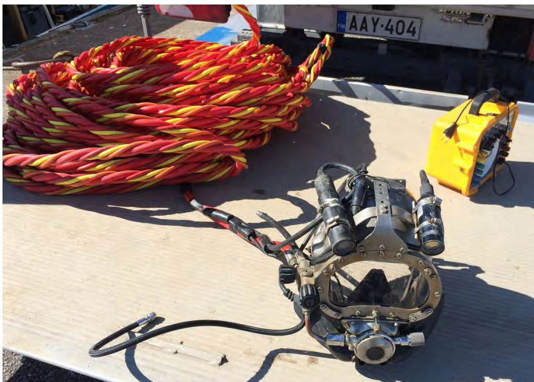
Kuva 4. Sukeltajan Kirby Morgan 37 kypärä, jossa valo sekä video. Vasemmalla umbilikaali ja oikealla radion pintayksikkö. (Kuvaaja: Immi Wallin. AKMA201505:2)
