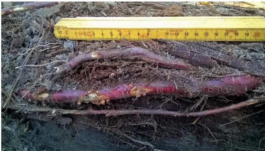
Kuva 9. Kölin sisään tunkeutuneita juuria. Kuva: Subreering.
