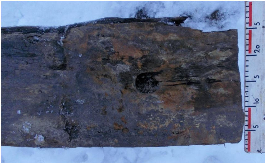
Kuva 12. Lapaliitos kappaleen SB1 ulkopinnassa. Kuva: Subreering.
