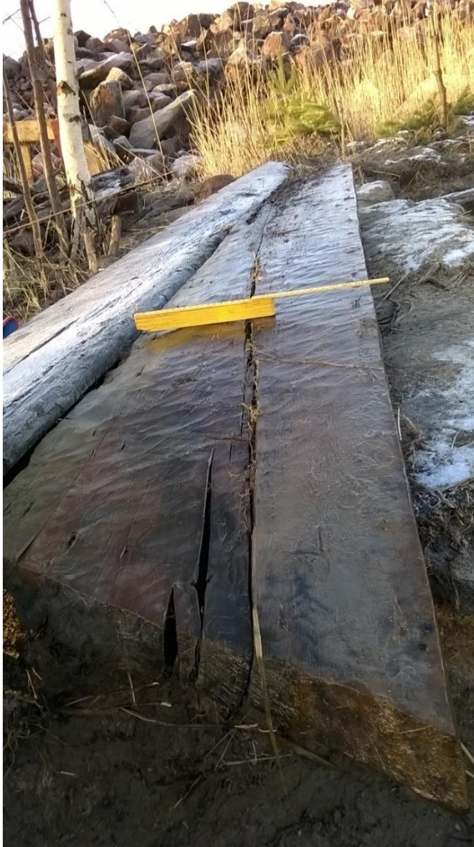
Kuva 14. Pohjalauta SB1. Työkalun jäljet erottuvat puun pinnassa. Kuva: Subreering
