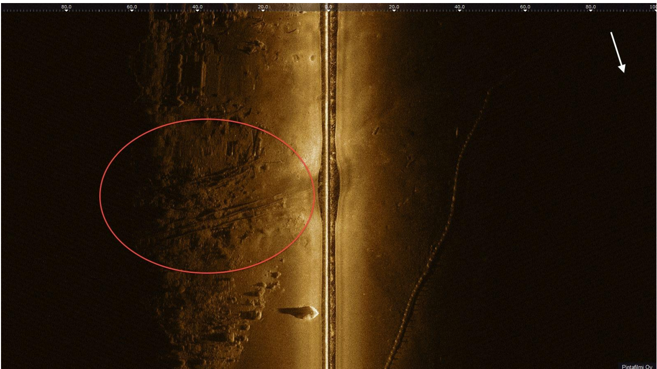
Kuva 17. Viistokaikuluotauskuva kohteesta 5. Pohjoisimmat telakanraiteet Mansikkasaaren telakan edustalla. Raiteet on numeroitu pohjoisesta alkaen tunnisteilla 1 ja 2.
