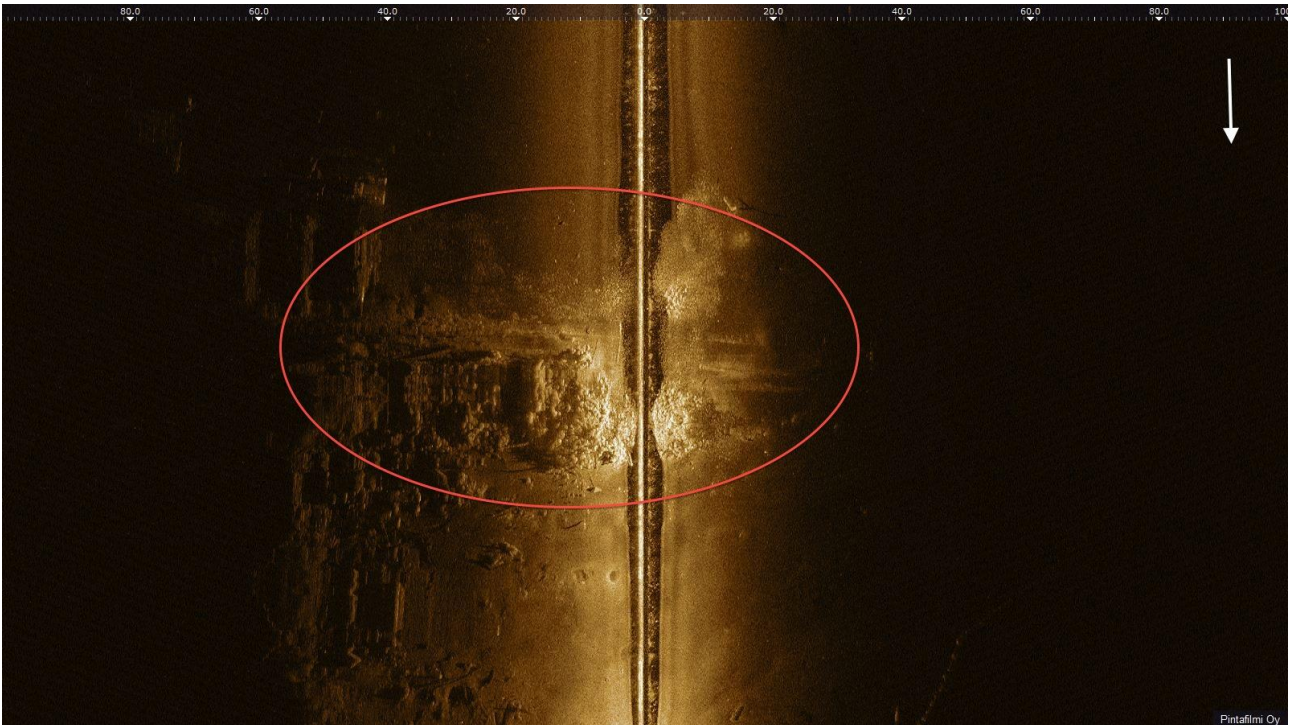
Kuva 18. Viistokaikuluotauskuva kohteesta 5. Telakanraiteet numero 3 raiteiden 1 ja 2 eteläpuolella.
