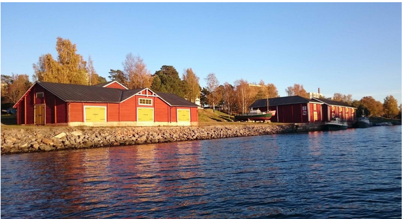
Kuva 3. Palosaaren makasiinimiljöötä. Kuvan etuosassa ranta on louhikkotäytteistä, mutta rannalle museoidun laivan edustalta lähtien harkkokivillä pengerrettyä. Kuvaussuunta on kaakkoon.
