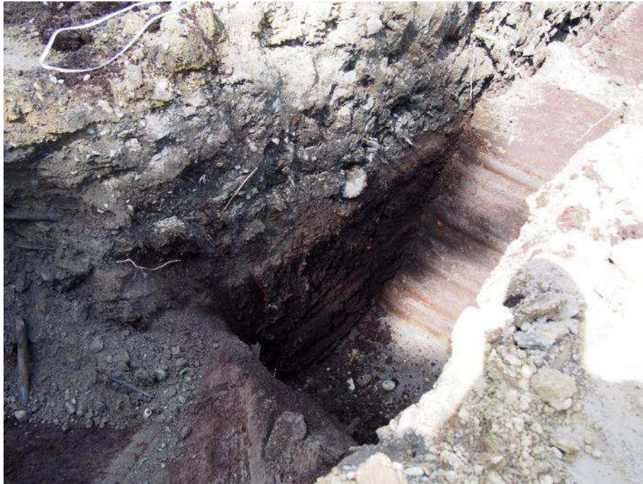
Kuva 6. Koeoja 1: n luoteisosaan (c) kaivettiin kuoppa kolmen metrin syvyyteen, jotta saatiin selville pohjasaven pinta. Kuopan pohjalle alkoi kertyä vettä ja kuopan reunat vaikuttivat huterilta, joten kuopan pohjalla ei käyty.
