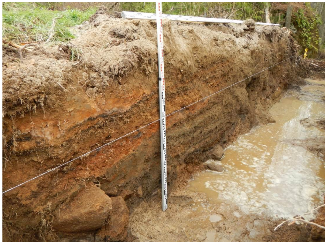
Kuva 10. Tiepohjan kerrostumia kohdassa 2, kaivannon länsiprofiili. Todennäköisesti kaikki kuvassa erottuvat kerrostumat on paikalle 1900-luvun aikana tuotuja. Kaivanto täyttyi vedellä melko nopeasti.
