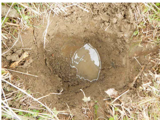
Kuva 13. koekuopan numero 23 pohjalle kertyi vettä välittömästi, kun sen pohjataso oli saavutettu. (Kuva: Tampere Rusko 2015: 6)
