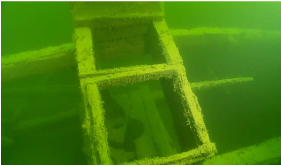
Kuva 22, Keulakannen luukun raamin alapuolella ruumassa keulamaston läpivienti, Juha Lauron videolta 2015.
