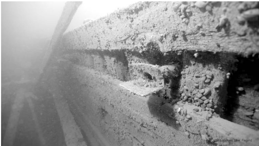
Kuva 12, Metallivahvisteinen läpivienti aluksen paapuurin kyljellä, laidan sisäpuolelta kuvattuna, Richard Ellerin videolta 2015.
