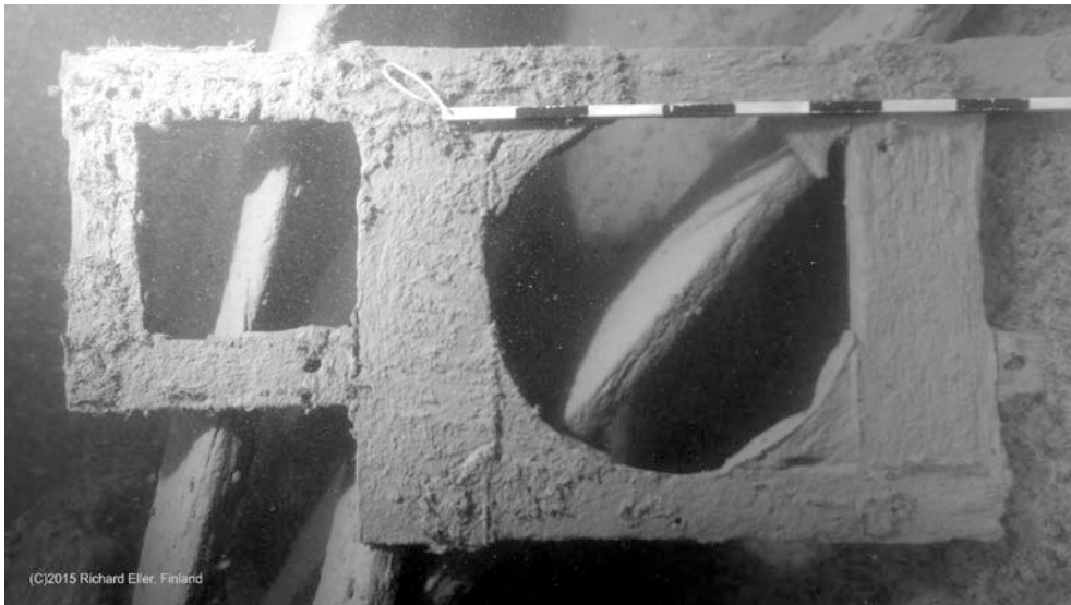
Kuva 24, Taemman maston läpiviennin jäänteitä ruumassa, Richard Ellerin videolta 2015.
