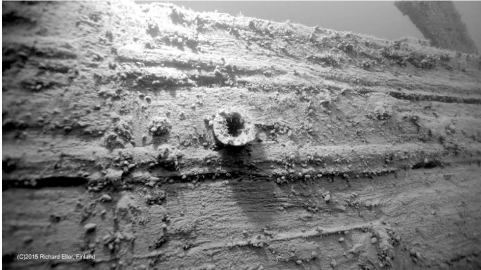
Kuva 11, Metallivahvisteinen läpivienti aluksen paapuurin kyljellä, laidan ulkopuolelta kuvattuna, Richard Ellerin videolta 2015.
