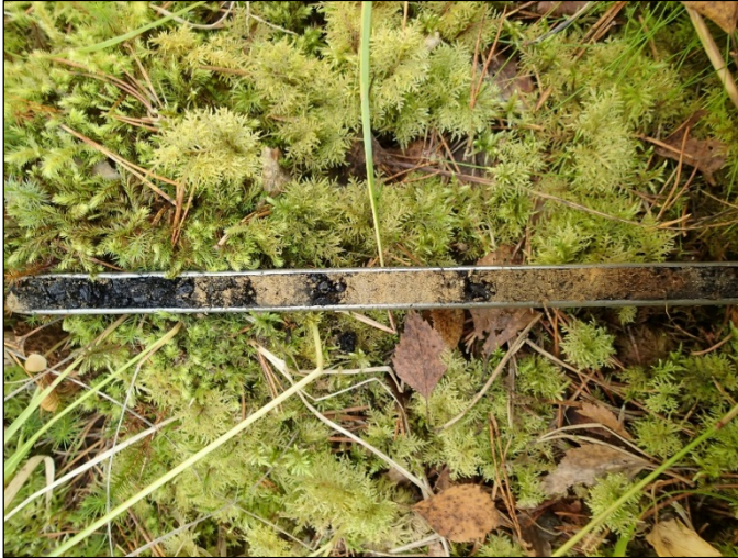
Hiiltä näytteessä, joka otettu maanäyte- kairalla Vihtalahden hiilihaudasta.
